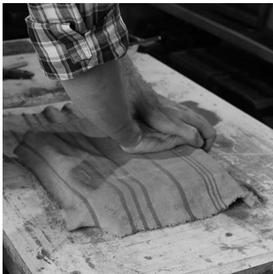
Rongyon keresztül belenyomják az agyagot a dúcba
