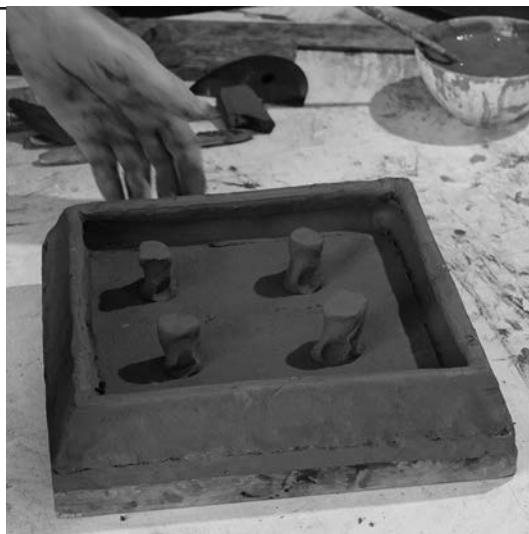
A támasztók behelyezése
